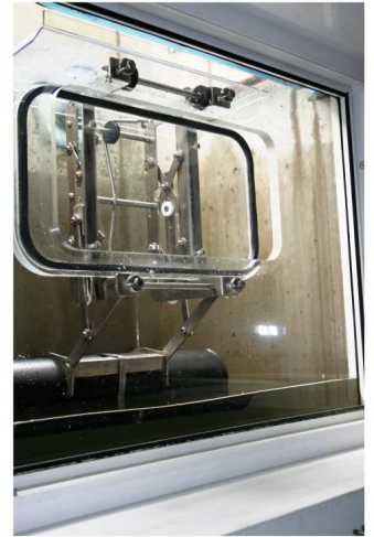
Automatisches Chiemgauer Hochwasserfenster: der Schwimmer geht nach unten - die Luke öffnet!
