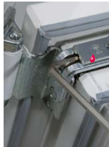
Seitenverstellung oben + / - 2 mm
