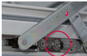
Flügelandruckeinstellung an der Schere oben + / - 1 mm
