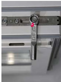
Sicherheits-Pilzzapfen Flügelandruckeinstellung (SW 11) + / - 1 mm
