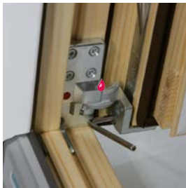
Seitenverstellung unten + / - 2 mm
