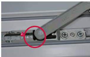
Sicherheits-Pilzzapfen Automatische Höhen- einstellung zum Falz- luftausgleich bzw. durch Handeinstellung + 2,5 mm
