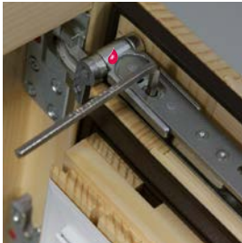
Seitenverstellung oben + / - 2 mm
