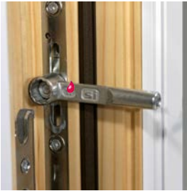
Sicherheits-Pilzzapfen Flügelandruckeinstellung (SW 11) + / - 1 mm
